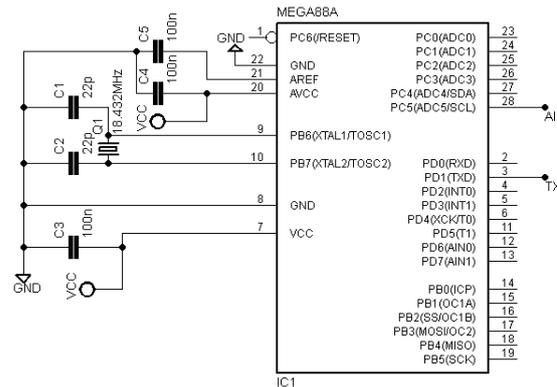
Fig. 4: Microcontroller circuit.
